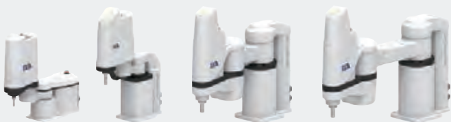
Standard- und Hochgeschwindigkeits-Typ (Hub Vertikalachse: 50/150/180/330 mm)
