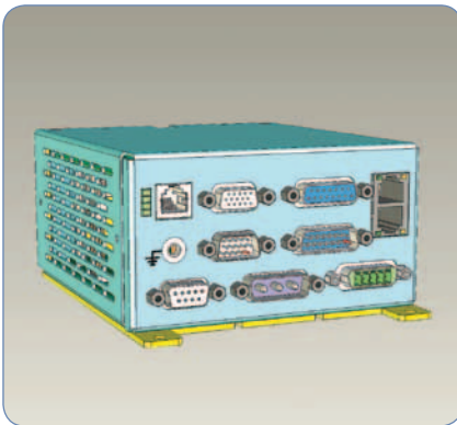
Verstärker für die medizinische Diagnostik, mit optimiertem Form-Faktor, I/O und verbesserten EMV-Eigenschaften
