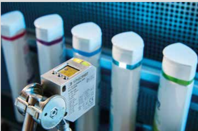
Farberkennung von Verpackungselementen
