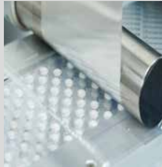
Überprüfung von glänzenden Blister-Kavitäten
