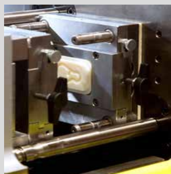
Leerkontrolle in Spritzgusswerkzeugen bei großer Distanz
