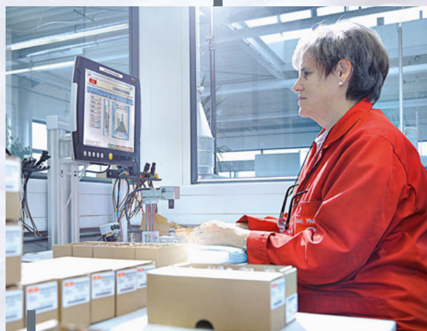
Vollautomatische Schaltpunkteinstellung mit EDV-gestützter Dokumentation der Messwerte.
