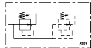
FR21 = Batterieregler ohne Sekundärentlüftung und ohne Manometer
